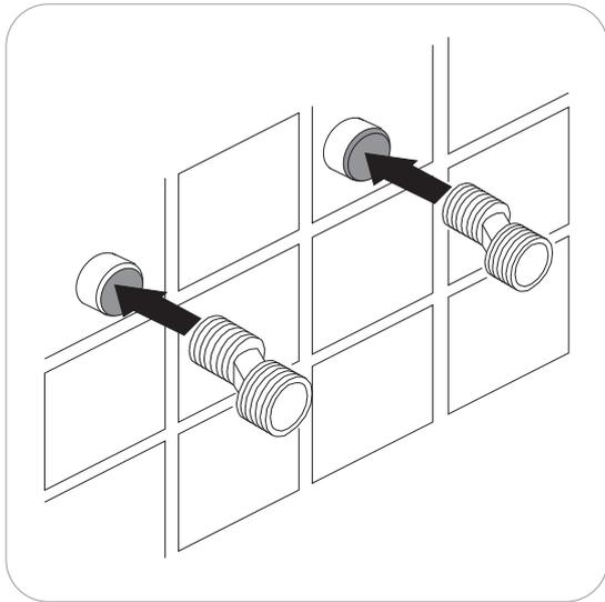
**1.** Schrauben Sie die Exzenteranschlüsse (18) an die Abschnitte der Anlage ein, die im Innengewinde G1/2 enden, und dichten Sie den Anschluss mit einer geeigneten Menge Teflonfaden und -band ab.
